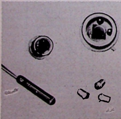
Afb. 44. Enige uitvoeringsvormen van fotodioden en transistoren van Texas Instruments.
